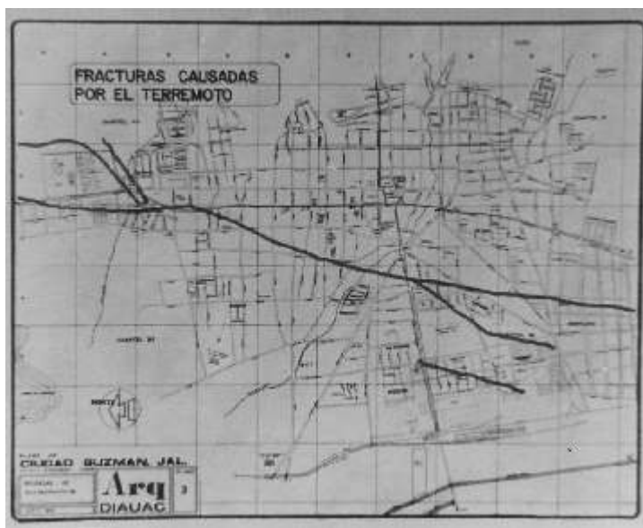
PLANO DE LOS DAÑOS OCASIONADOS POR EL TERREMOTO DE SEPTIEMBRE DE 1985, EN CIUDAD GUZMÁN JALISCO, A PARTIR DE UN LEVANTAMIENTO ELABORADO POR UNA BRIGADA DE ARQUITECTURA DE LA UAC, QUE SE TRASLADO A ESA CIUDAD, EN APOYO A LA POBLACIÓN DAÑADA POR EL SISMO.
